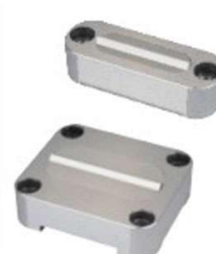
Z5140 D10 限位夾 SLIDE RETAINER M 材質 1.2343 H 硬度 HRC54°±2°
